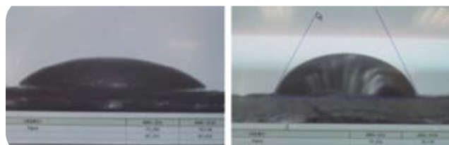
Imagen del ángulo de contacto del diiodometano sobre la superficie metálica. A la izquierda sobre la laca transparente texturada normal y a la derecha sobre la laca transparente texturada antiadherente
