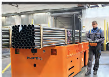
Transportador de plataforma de carga pesada SFX
