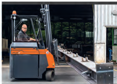
FLUX Carretilla frontal multidireccional
