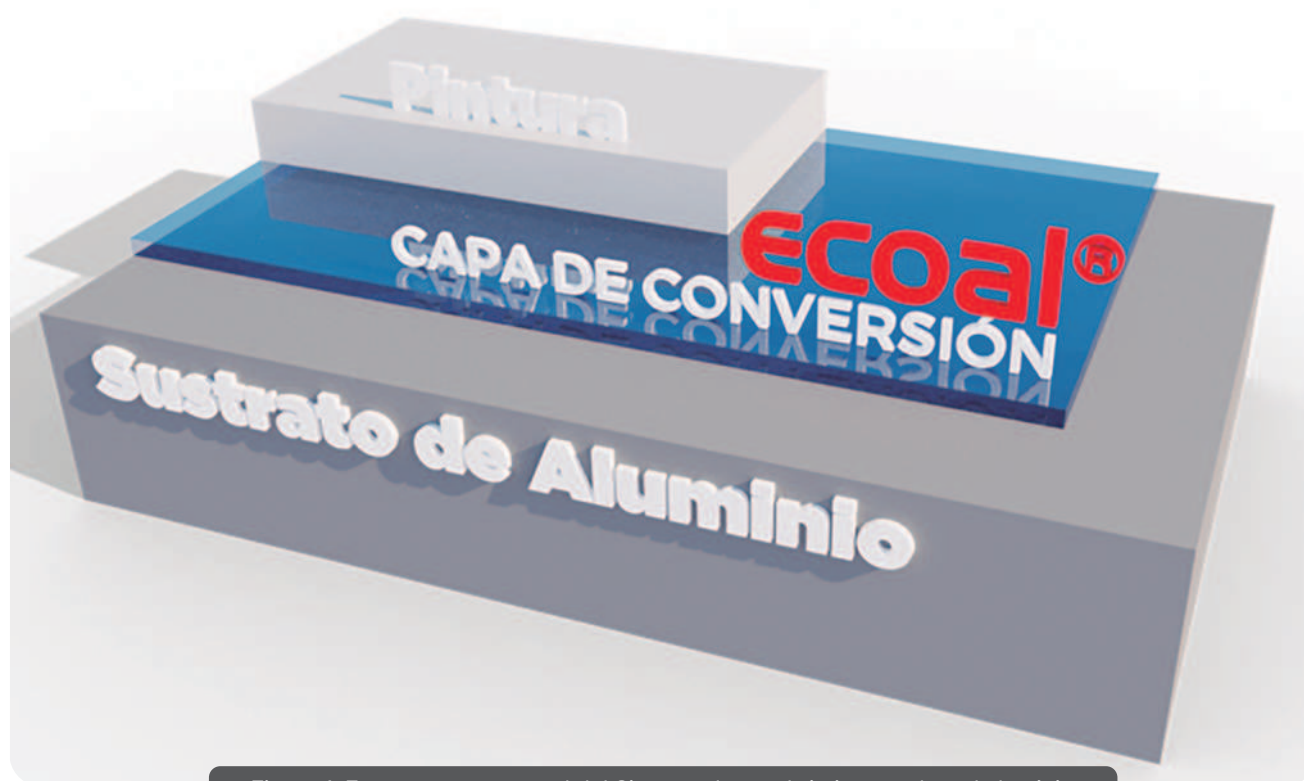
Figura 1. Esquema conceptual del Sistema de recubrimiento sobre el aluminio
