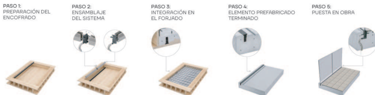
Detalle de las principales fases del proceso de fabricación de Glass Rail PRO © Exlabesa Building Systems
